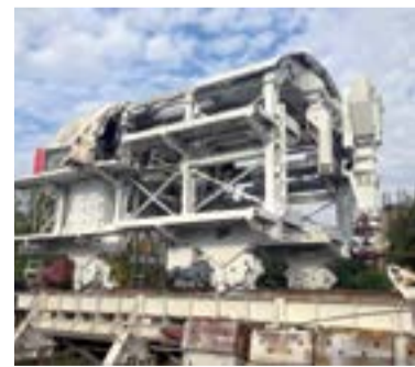
Укладчик для проходки боковых станционных тоннелей УС-01
