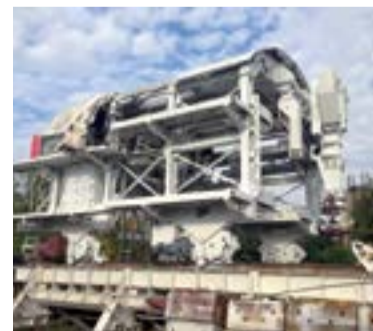
Укладчик для проходки боковых станционных тоннелей УС-01
